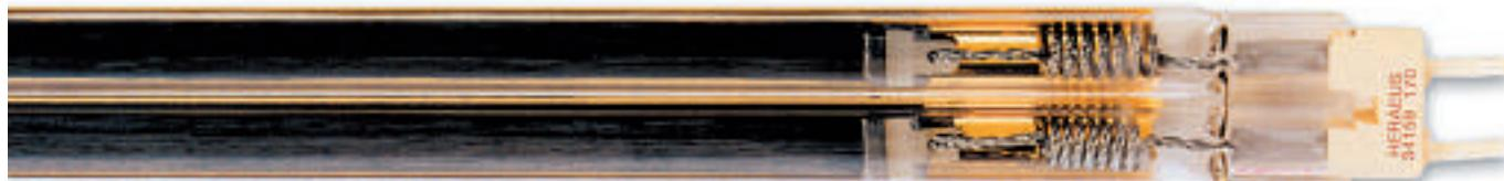
Auf Ihre Anwendung abgestimmte Infrarostrahler im mittel- und kurzwelligen Bereich. Extrem hoher Wirkungsgrad – ideal für Trocknungsprozesse und zur Erwärmung von Kunststoffen und anderen Materialien. Aufheiz- und Auskühlzeiten in wenigen Sekunden; beheizte Längen von 40-6000 mm.
