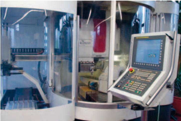
Höchste Flexibilität für Einzelstücke und kleine Serien bietet die CNC-Werkzeugschleifmaschine Helitronic Power mit Palettenlader und Scheibenwechsler
