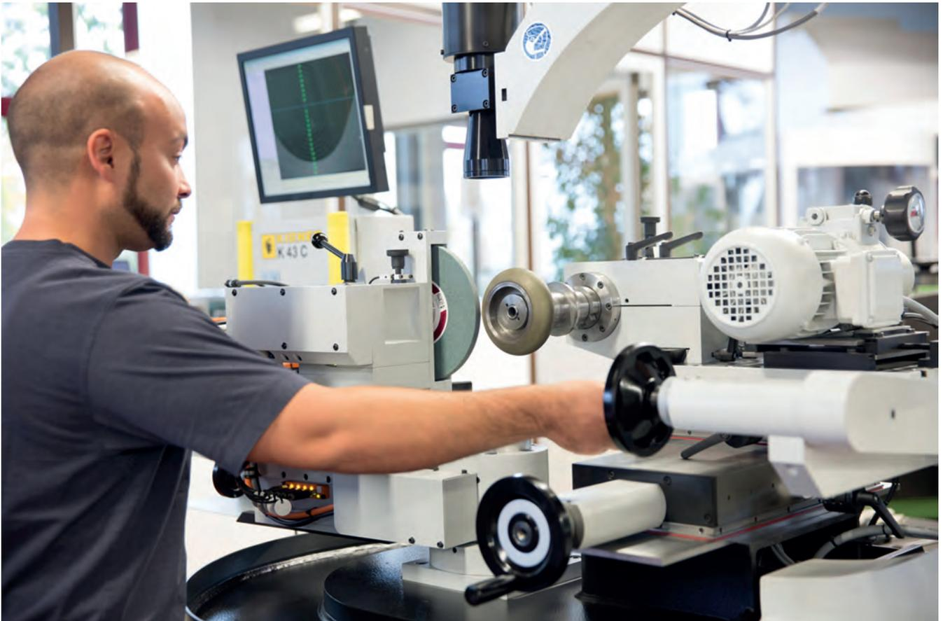
Bild 1: Präzise und einfach zu bedienen: Abrichtmaschine K 43 C von Kirner
