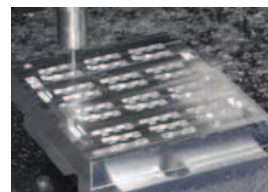
Die Fräsmaschine Datron M10 Pro ermöglicht die gratfreie Bearbeitung des Werkstücks. Bild: Datron
