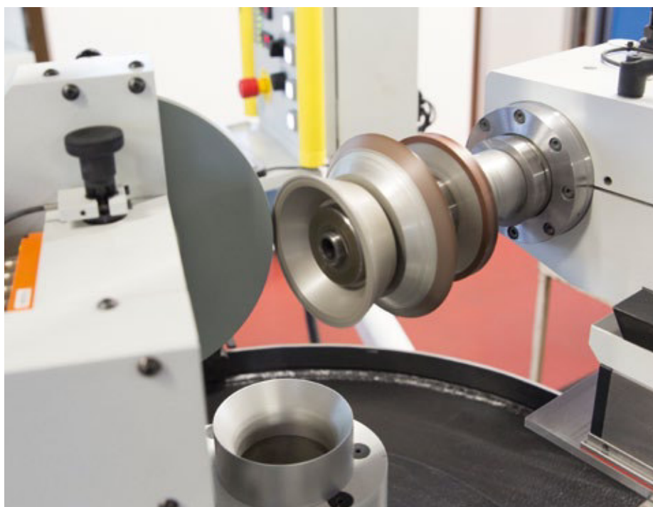
Abrichten von Einzelscheiben oder kompletten Scheibensätzen.
