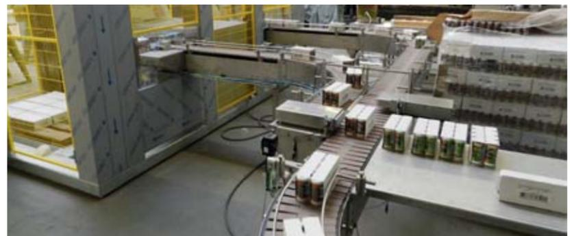
Die Trays werden automatisch nach den beiden Produktsorten des Herstellers zugeordnet und der Zelle zugeführt.
