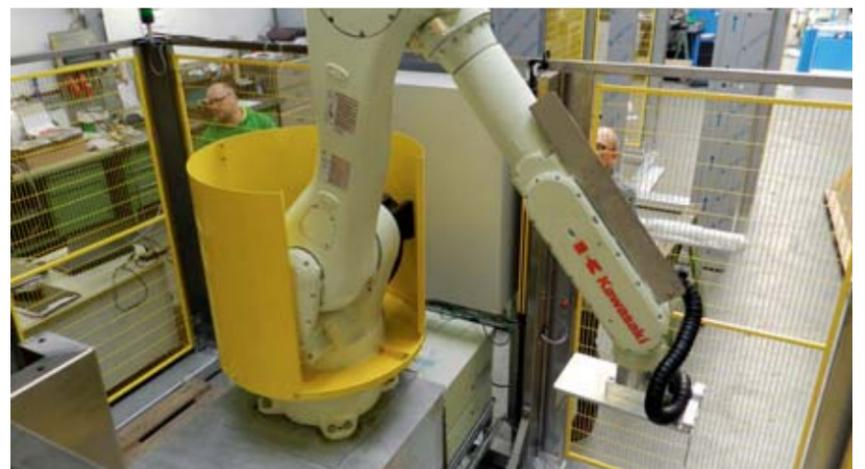
Die für einen führenden Gewürzhersteller entwickelte Doppelpalettierzelle der Firma Ecoma Maschinenbau setzt auf einen Kawasaki Roboter RD80N.
